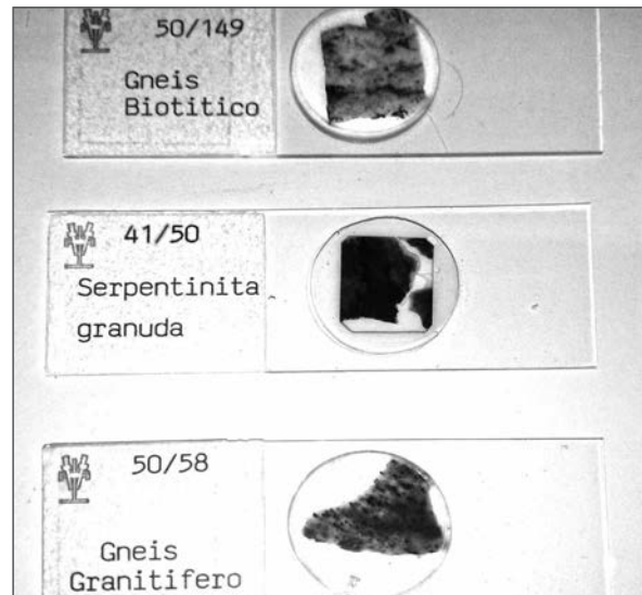
Detalls de les preparacions de roques destinades a ser observades amb llum incident.
